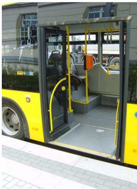
Rys. 9.9. Przerwa między peronem przystankowym a autobusem. Źródło: opracowanie własne.
